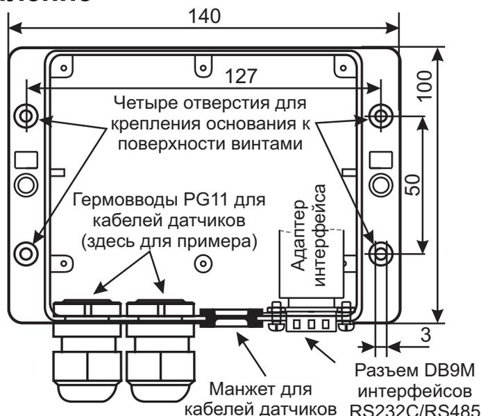
Рисунок 5.1 – Схема крепления корпуса ВКТ-7
