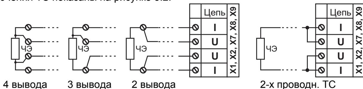
Рисунок 5.2 - Монтаж ТС к линии связи
