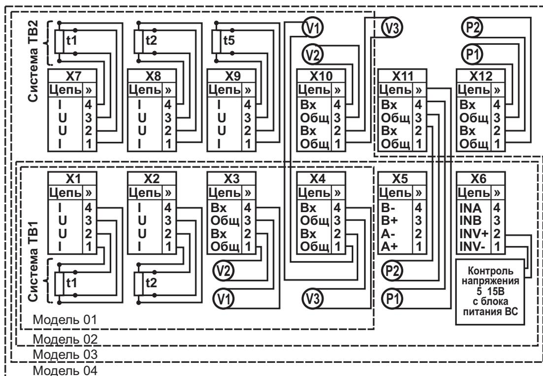
Рисунок 5.4 – Подключение датчиков к разъемам ВКТ-7
