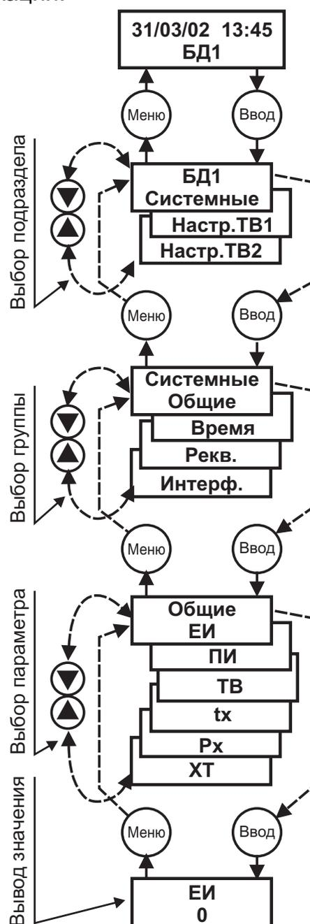
Рис. 3.5 – Пример вывода значения параметра **ЕИ**
