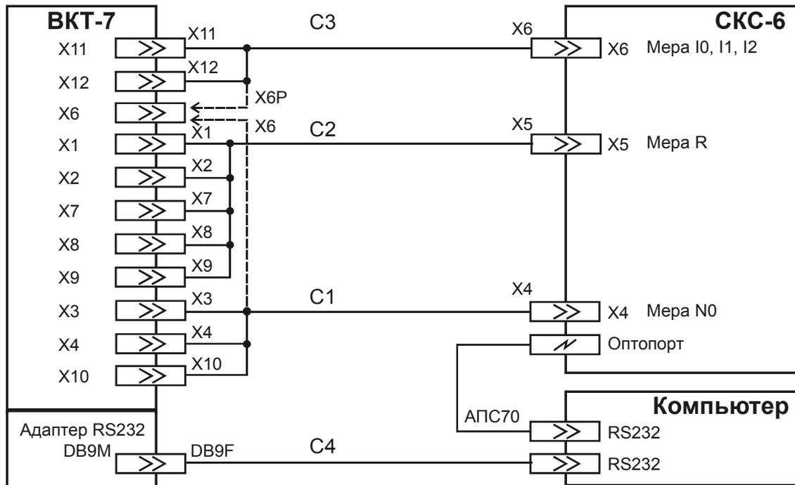
Рисунок 8.1 – Схема поверки
