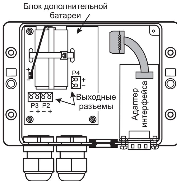
Рисунок Е1 – Внешний вид и способ крепления блока дополнительной батареи
